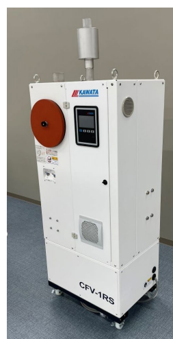
正転逆転切り替えによる攪拌・排出方式
