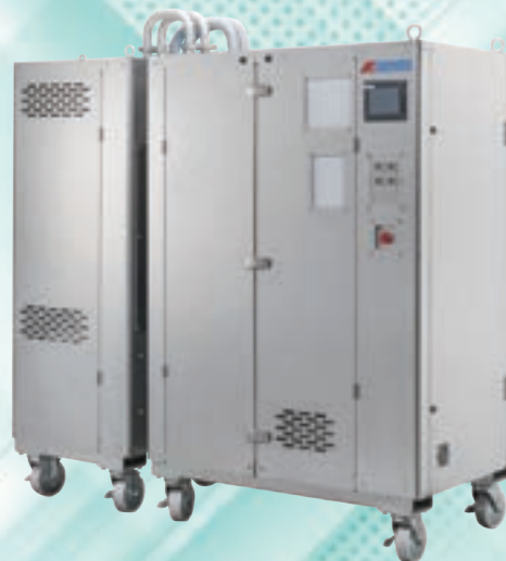
ハリコーター 微粒子表面連続コーティング装置
