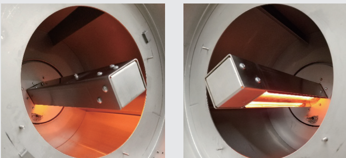
材料をソフトに攪拌しながら赤外線直接加熱
