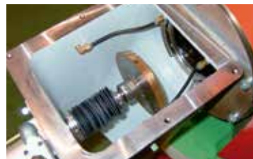
排出ドアメタルタッチ (蛇腹付) Metal touch discharge door (with bellows)
