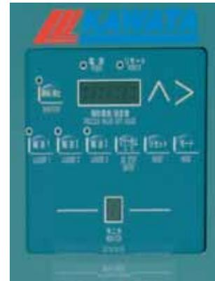
●マイコンのフル活用による自動運転と、アラーム機能を兼ね備えた専用コントローラを装備しています。乾燥温度は、PID制御による高精度な温度制御を実現。また、設定・指示値は確認しやすいデジタル表示です。外部信号でのリモート運転、タイマー運転も標準装備しています。
