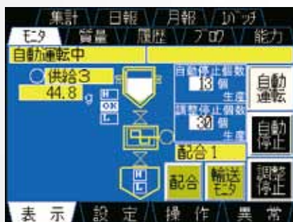
残生産個数を指定する方法 How to preset remaining production quantity
